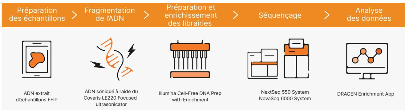
Figure 1 : Flux de travail Illumina Cell-Free DNA Prep with Enrichment pour le traitement des échantillons FFIP.
